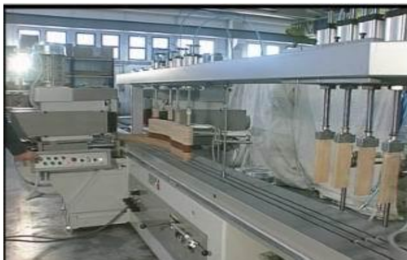
Máy FC4: chép hình biên dạng 2 mặt chà nhám tự động
